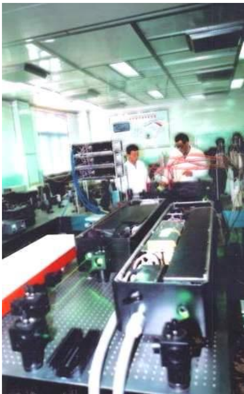
Рис. 01 Комплекс перестраиваемых лазеров для лазерной резонансной фотоионизации атомов
